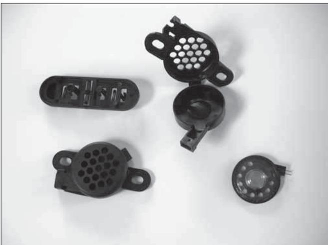
Lautsprechergehäuse für Rückfahrlampe, demontiert (Lautsprecher rechts unten)
